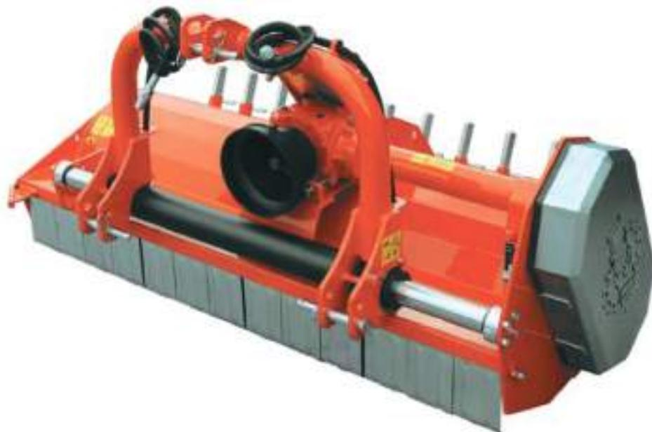
Il Trinciaturto TLSP è un'attrezzatura utilizzata per la trinciatura di erba e sarmenti, di potatura di vigneti, frutteti e uliveti. Dispone di attacco a tre punti ed è applicabile a trattori cingolate e gommate. Il trinciaturto TLSP si caratterizza per lo spostamento idraulico (max 40 cm) che ne consente l'impiego in posizione decentrata per lavori di accostamento alle colture.
